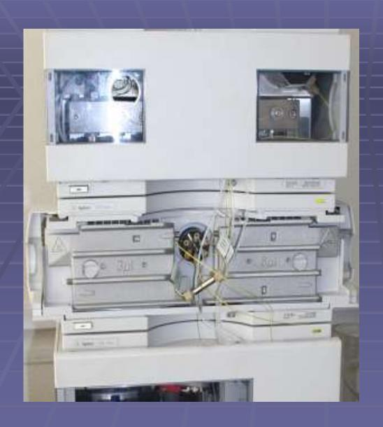
Система жидкостной хроматографии - массспектрометрии Agilent - один из основных инструментов протеомики
