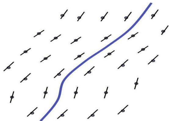
в каждой точке  $(x, y)$  плоскости  $Oxy$  задает направление интегральной кривой.
