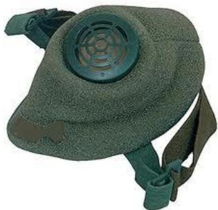
Респираторы Р-2 изготавливаются трех размеров. Для подбора респиратора измеряют высоту лица: 99-109 мм - 1-й размер, 100-119 мм - 2-й и более 119 мм - 3-й. Для детей младшего возраста дополнительно выпускаются респираторы нулевого размера (Р-2д). Время защитного действия респиратора Р-2 не более 12 ч, Р-2д - 4 ч.
