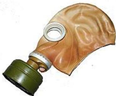
В комплект гражданского фильтрующего противогаза ГП-5 входят два основных элемента: фильтрующе-поглощающая коробка ГП-5 и лицевая часть (шлем-маска ШМ-62у). Внутри фильтрующе-поглощающей коробки ГП-5 расположены противоаэрозольный фильтр и шихта (поглотитель). Лицевая часть представляет собой шлем-маску ШМ-62у, изготовленную из натурального или синтетического каучука. В шлем-маску вмонтированы очковый узел и клапанная коробка.
