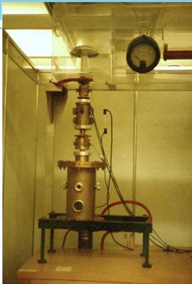
Первый электронный микроскоп, сконструированный Э.Руской и М.Кнорром в 1931 г. И схема его устройства
