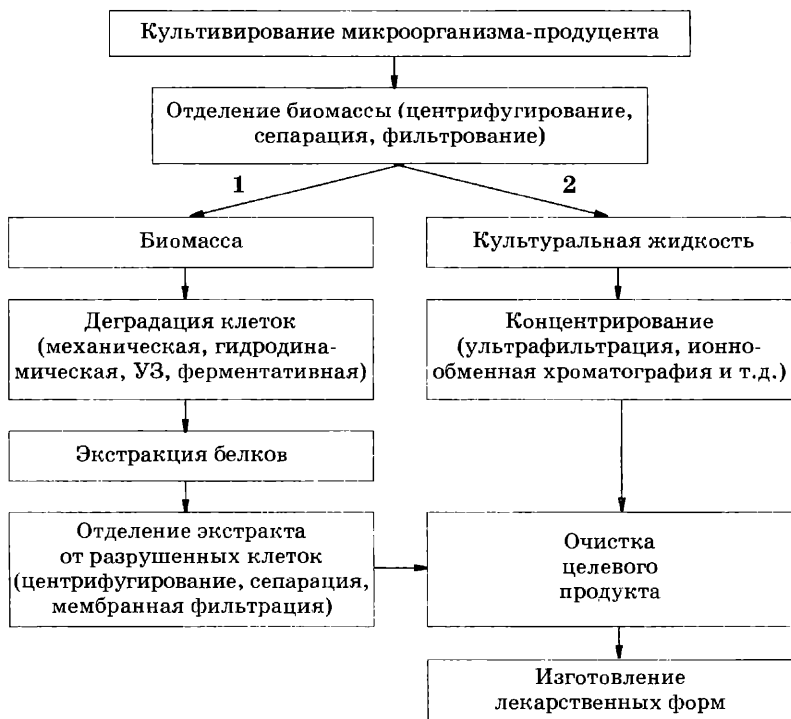
Рис. 7.2. Технология получения ферментов биотехнологическими методами:
