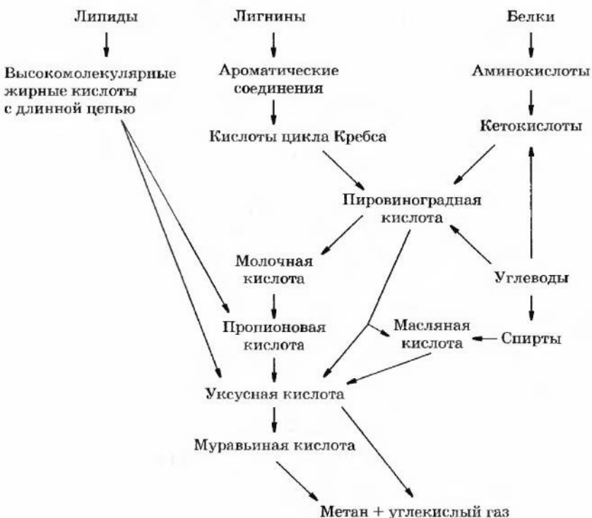
Рис. 8.2. Биохимическое расщепление отдельных соединений до метана и углекислого газа при анаэробном расщеплении отходов (по И. Хиггинсу и др., 1988)
