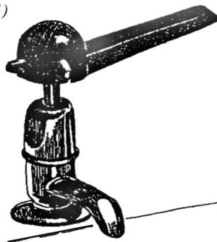
Рис. 30. Специальные ручки для включения электрических и газовых плит (а) и водопроводного крана (б) (по Э. Н. Деминой и И. П. Сергеевой)
