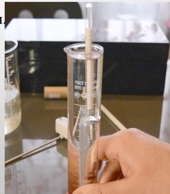
4. По окончании работы ареометр моют, ополаскивают дистиллированной водой, протирают фильтровальной бумагой и убирают в футляр.
