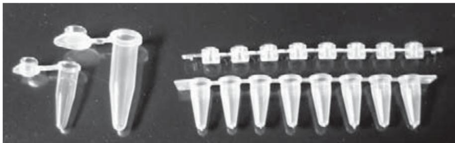
**Рис. 2.2.** Примеры пробирок для проведения ПЦР
