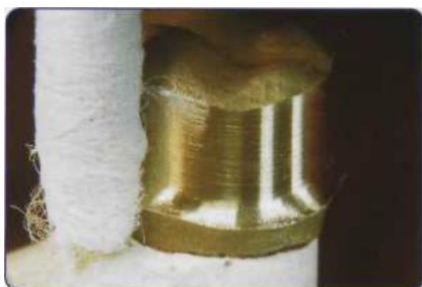
Рис. 13. Финишная обработка ватой алмазной полировочной пастой
