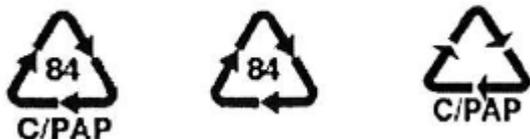
Примечания: 1. Знаки идентификации проставляются следующим образом: внутри петли Мебиуса - цифровой код и (или) буквенное обозначение, под петлей Мебиуса - рисунок 2 в соответствии с Приложением 4 к техническому регламенту Таможенного союза "О безопасности упаковки" (ТР ТС 005/2011).
