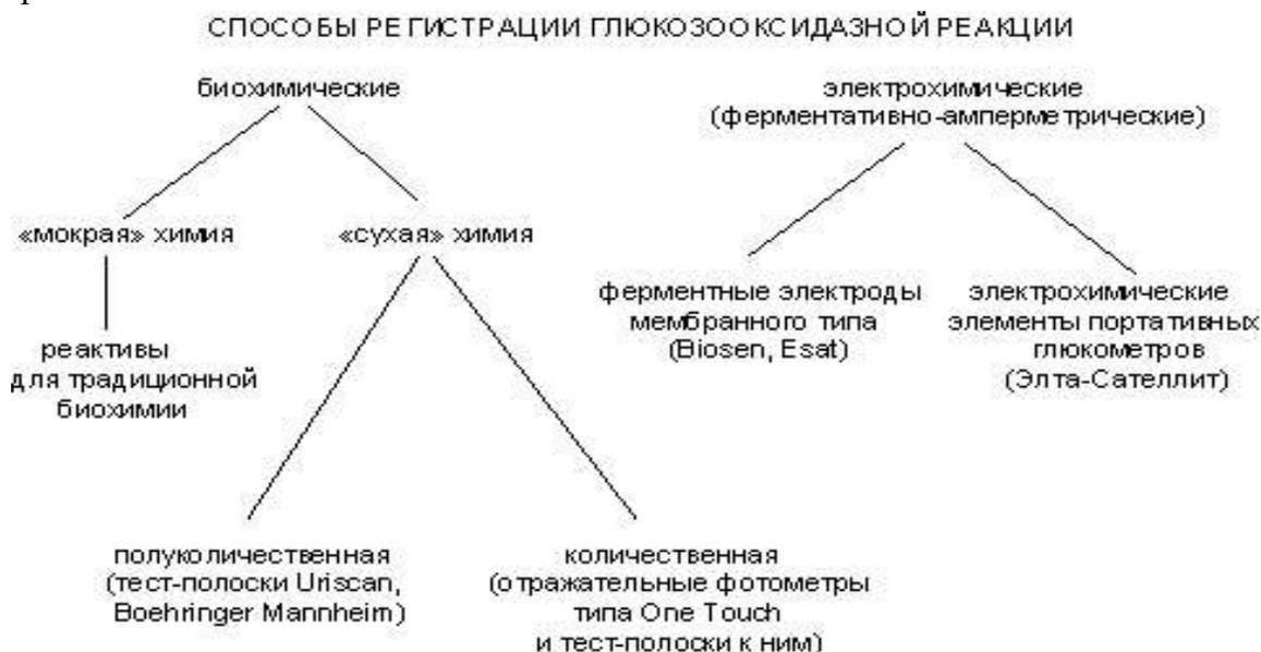
Среди вышеперечисленных способов регистрации наибольшее распространение получил **фотометрический биохимический метод**, в котором молекулы перекиси водорода под действием фермента пероксидазы расщепляются с образованием активной формы кислорода – супероксид анион-радикала –  $O_2^-$ , который в свою очередь окисляет хромоген, что приводит к значительному изменению спектра поглощения хромогена.
