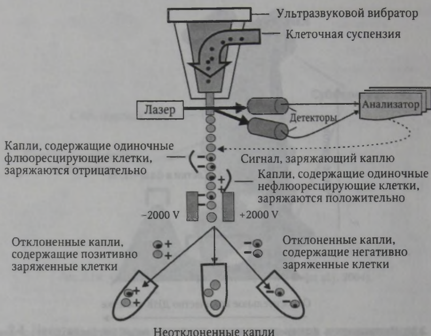
Рис. 2.21. Схема автоматической сортировки клеток на основе активации сигнала специфической флуоресценцией (Alberts B. [et al.], 2004)
