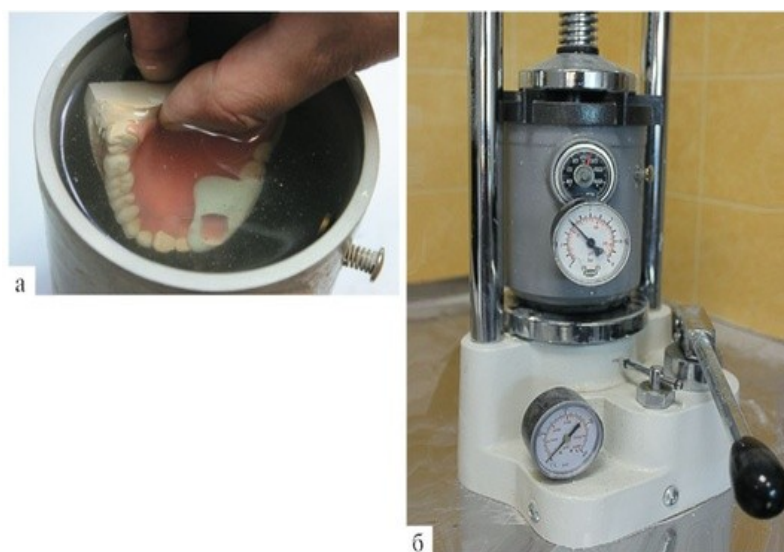
Рис. 12. Всю конструкцию помещают в полимеризатор (а) и устанавливают под гидравлический пресс (б)
