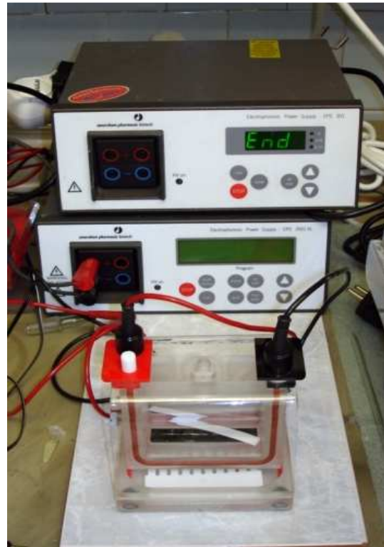
Рис. 7. Прибор для одномерного электрофореза (источник питания и камера)
