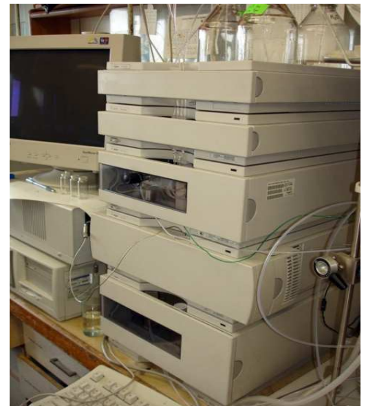
Рис. 4. Хроматограф ВЭЖХ (Agilent 1100)
