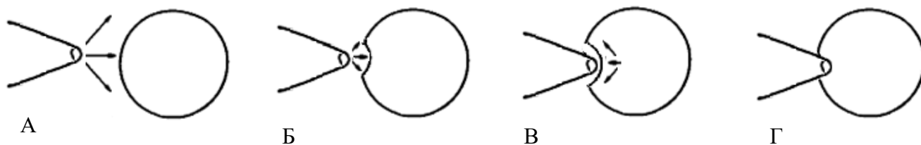
Рисунок4. Образование гигаомного контакта микроэлектрода с мембраной клетки. А) На микропипетку подается небольшое позитивное давление. Б) Приближаясь к мембране, возникает инвагинация. В) Сброс давления, при этом мембрана схлопывается с отверстием микропипетки, наблюдается быстрый рост сопротивления. Г) Сопротивление вырастает порядка ГОм, (возникновение гигаомного контакта)
