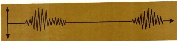
КОЛОКОЛОБРАЗНАЯ ФОРМА КОЛЕБАНИЙ, ПОЛУЧАЕМЫХ ОТ АППАРАТА ИСКРА - I
