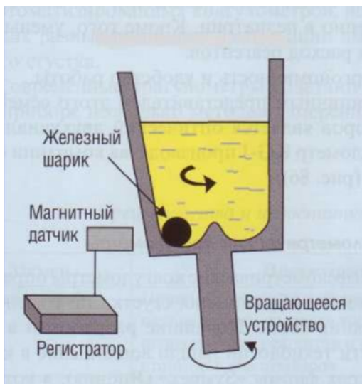
Рис. 83. Принцип работы механического коагулометра. Кювета с плазмой расположена под наклоном и вращается, шарик стоит на месте, не вращается. В момент свертывания шарик захватывается сгустком; как только шарик уходит от датчика, меняется магнитное поле, прибор регистрирует момент свертывания плазмы
