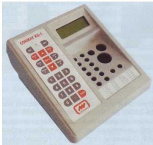
Рис. 86. Оптический двухканальный коагулометр KG-1 производства компании «Сорма». Точность результатов повышается за счет синхронизации времени попадания реагента в измерительную кювету и запуска отсчета времени, а также исключения из применения магнитных мешалок в измерительных кюветах. Прибор эргономичен, термостат для проб и реагентов размещен в самом приборе, у кювет есть перемычки и держатели для удобства переноса из термостата в измерительные ячейки. Работа на приборе экономна, так как снижен расход реагентов за счет уменьшения объема кювет, использования многоразовых кювет
