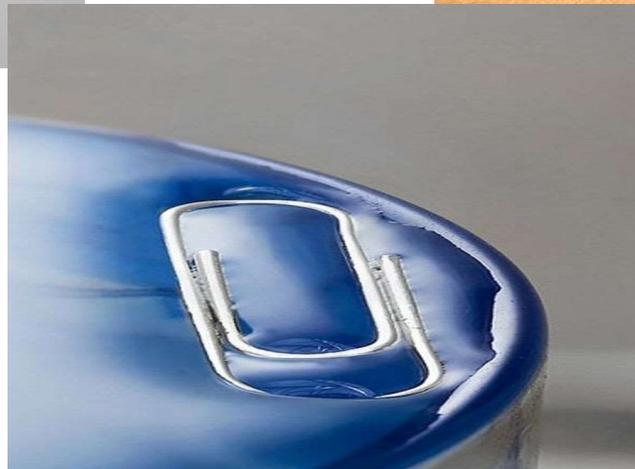
**Сила**, действующая на единицу длины контура, ограничивающего поверхность раздела фаз, и обуславливающая сокращение поверхности жидкости, называется **поверхностным натяжением** ( $\sigma$ ) и имеет в этом случае размерность [мН/м] или [дин/см].
