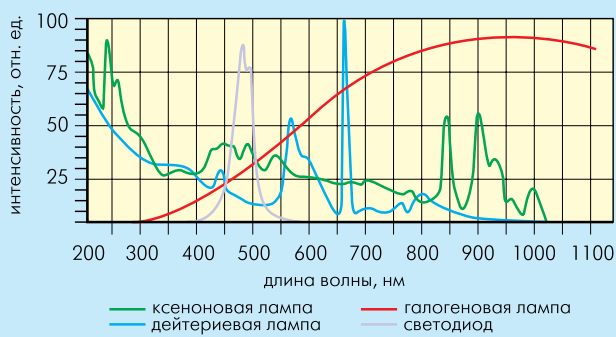
Рис. 3 Спектры основных источников света, используемых в спектроскопии клеток
