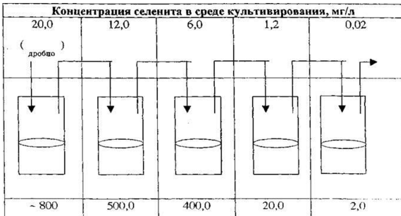
Рис. 2. Расчетное, содержание селена в биомассе дрожжей при использовании, батареи ферментеров, работающих последовательно
