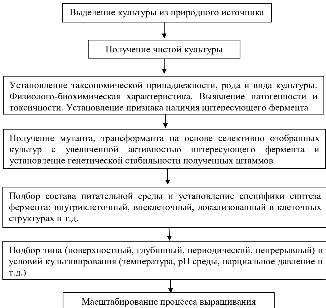
Рис. 1. Последовательность этапов выделения и обработки культуры микроорганизма из природного источника для получения промышленных штаммов продуцентов ферментов
