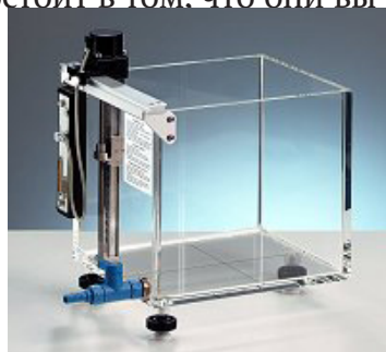
Рис. 8. Водный фантом для проведения дозиметрических измерений
