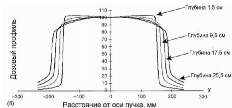
Рис.10. Дозовый профиль пучка тормозного 6-мегавольтного излучения на разных глубинах в водном фантоме для размера поля 30 \times 30 \text{ см}^2 на поверхности фантома
