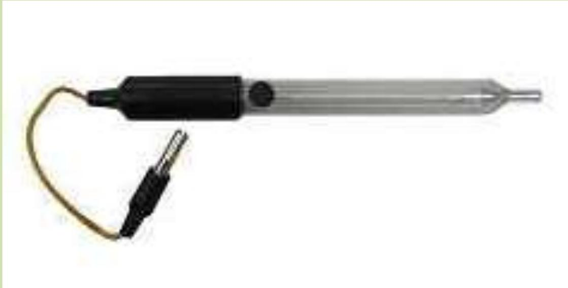
В насыщенном растворе  $KCl$  при температуре  $25^{\circ}C$  потенциал хлорсеребряного электрода  $\varphi = 0,22\text{ В}$
