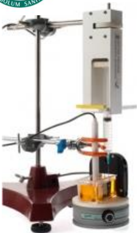
Лабораторная установка «Кондуктометрия»
