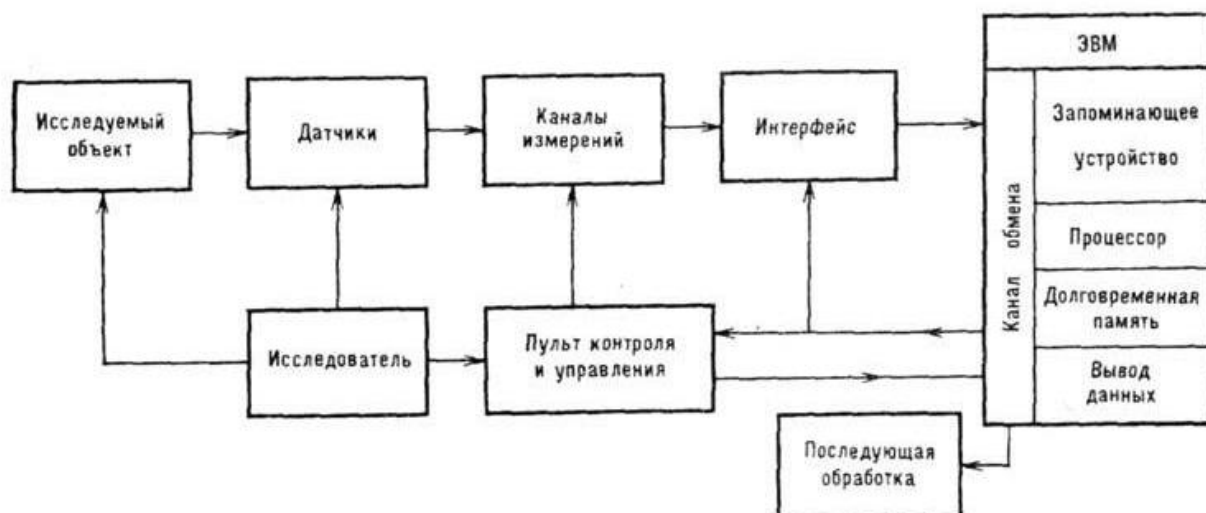
Рис. 3.1. Структурная схема автоматизированной системы экспериментальных исследований.
