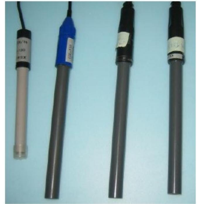
в) Ионселективные электроды для определения  $\text{Cl}^-$ ,  $\text{Ca}^{2+}$ ,  $\text{NH}_4^+$ ,  $\text{NO}_3^-$
