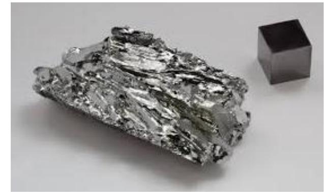
Внешне молибден представляет собой серебристо-белый металл, очень твердый (царапает стекло). Его относят к категории тугоплавких металлов, однако более чистый он становится более мягким.
