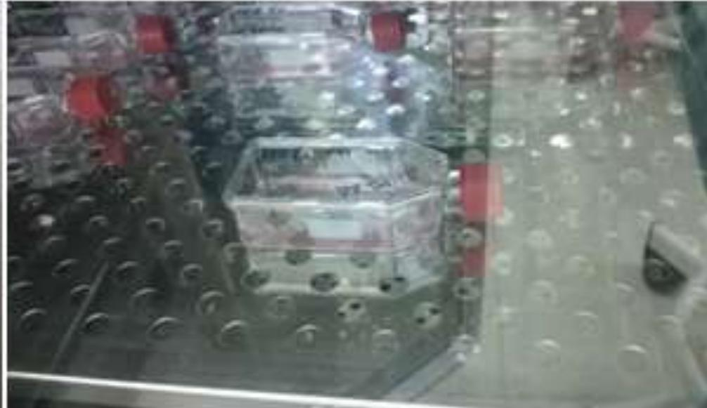
Воздух циркулирует вокруг инкубатора путем естественной конвекции или в результате использования вентилятора, который поддерживает как уровень CO<sub>2</sub>, так и температурный режим.
